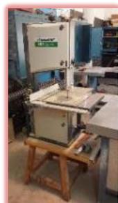
Sierra eléctrica para cortar madera, metal, plástico u otros materiales. Según el material a cortar se utilizan diferentes tipos de hojas.
