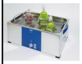
Coloquialmente conocido como sonicador. En el laboratorio, se utilizan baños de ultrasonidos para limpieza de diferentes elementos, mezcla, dispersión, desgasificación, favorecer ciertas reacciones, etc.
