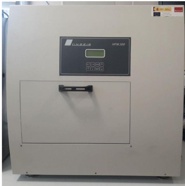
**Figura 1. Medidor de Flujo de Calor LINSEIS HFM 300.**
