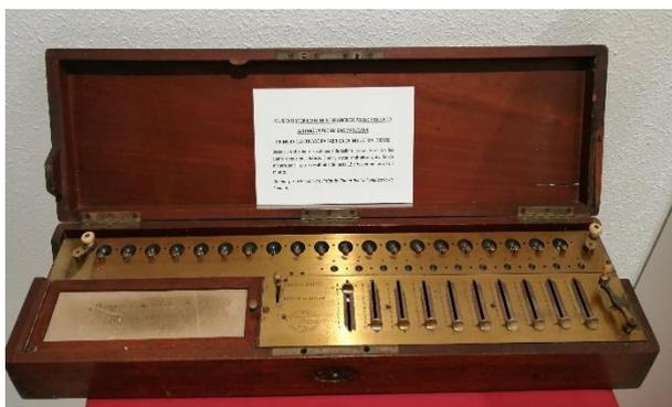
Esta máquina se construyó siguiendo el sistema del cilindro de Leibniz (1694) y era capaz de realizar cuatro operaciones básicas (sumar, restar, multiplicar y dividir) de manera sencilla con resultados de hasta 12 cifras.
