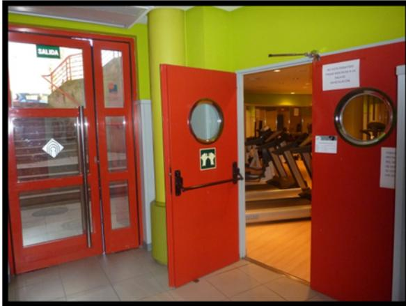
**A7:** Salida a calle desde planta sótano a través de puerta acristalada con estructura metálica que ofrece un ancho de paso de 0,90m.
