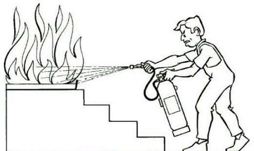
4. Dirigir el chorro a la base de las llamas con movimiento de barrido. En caso de incendio de líquidos proyectar superficialmente el agente extintor efectuando un barrido evitando que la propia presión de impulsión provoque derrame del líquido incendiado. Aproximarse lentamente al fuego hasta un máximo aproximado de un metro.
