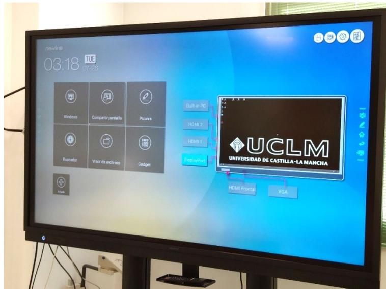
En la página principal de la pantalla, **seleccionar la entrada** (DisplayPort, HDM1 o HDM2) a la que esté conectado el ordenador que se vaya a utilizar y pulsar en la vista previa de dicha conexión.
